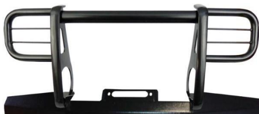
FIGURA 1: EXEMPLO DE PROTETOR E REFORÇO ESTRUTURAL DIANTEIRO COM MESA PARA GUINCHO ELÉTRICO.
